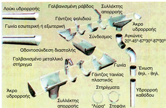
Σχ. 8-2.2γ. Εξαρτήματα για την κατασκευή υδρορροής σε στέγη.
