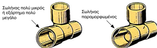
Σχ. 3-6.2α. Ελαττώματα που πρέπει να αποφεύγουμε κατά την τριχοειδή συγκόλληση.
