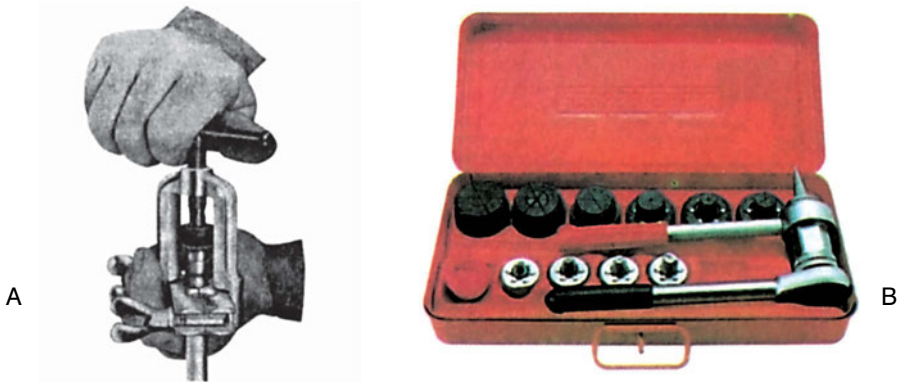
Σχ. 3-5.4ε. (A). Εκτόνωση με πλάκα και καβαλέτο. (B). Σειτ εκτονωτικών εργαλείων για υδραυλικούς, σε μεταλλική θήκη.
