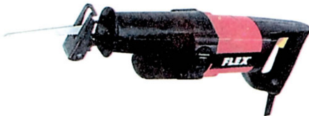
Σχ. 2 - 1.4ε. Ηλεκτρικό πριόνι με λάμα κατάλληλη για κοπή χαλυβδοσωλήνων.
