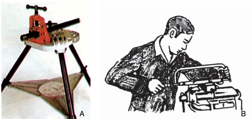
Σχ. 2 - 1.4β: (Α). Σύσφιξη σωλήνα σε σωληνομέγκενη (Β). Το κόψιμο σιδηροσωλήνα με σιδηροπρίονο.
