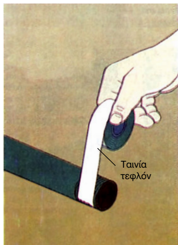
Σχ. 2-6.4α. Τοποθέτηση ταινίας τεφλόν σε σπείρωμα σωλήνα.
