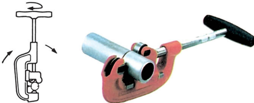
Σχ. 2 - 1.4δ. Διαδικασία κοπής σωλήνα με σωληνοκόφτη.
