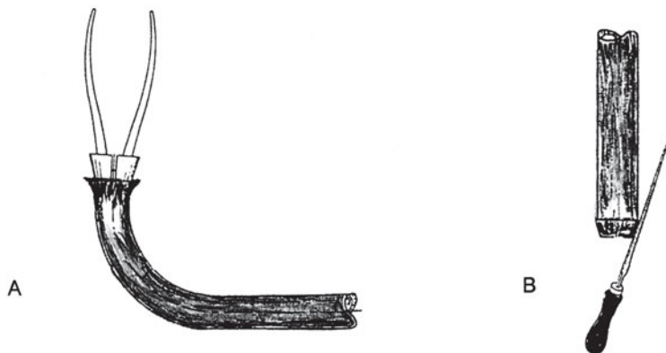
Σχ. 5-3.4β. (Α). Η εκχέλιωση του άκρου του μολυβδοσωλήνα με ταπόκι. (Β). Προετοιμασία του άλλου τεμαχίου (αρσενικού) με τη χρήση της ράσπας.
