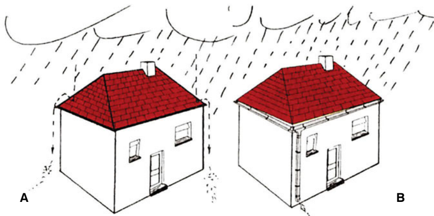
Σχ. 8-2.2α. (Α). Ελεύθερη απορροή βρόχινων νερών από στέγη. (Β). Συλλογή και απομάκρυνση βρόχινων νερών με συλλεκτήριους αγωγούς (ντερέδες).
