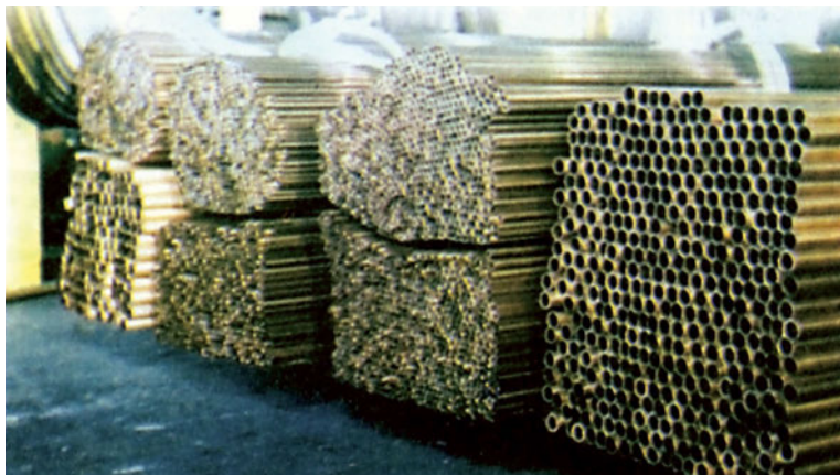
Σχ. 3-1 α. Χαλκοσωλήνες σε ράβδους (ευθύγραμμα τμήματα)
